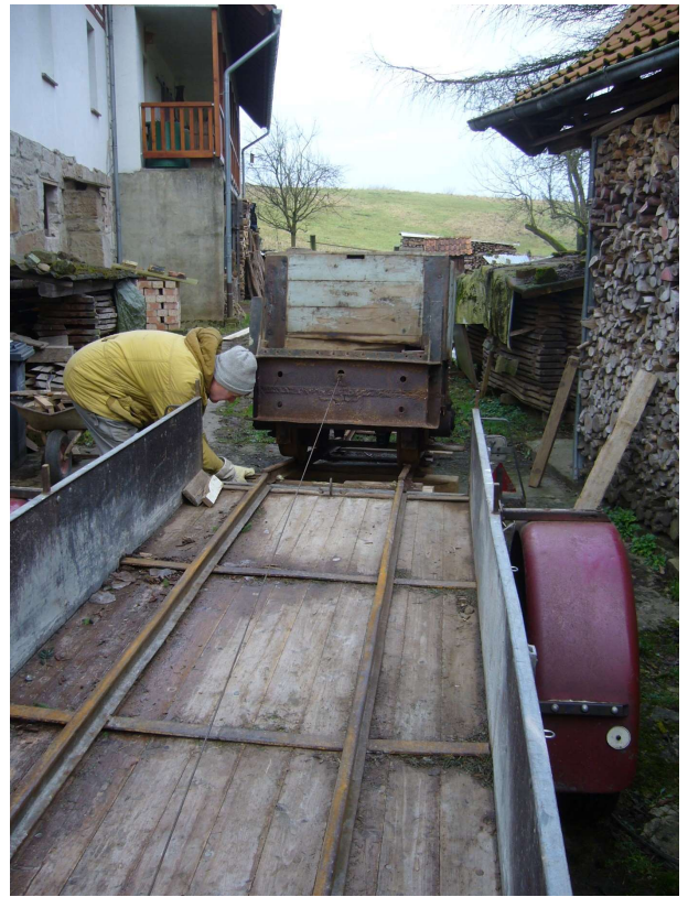
Mit der Seilwinde des Anhängers wurde das Stahlfahrwerk der E-Lok auf den PKW-Anhänger gezogen. Horst Kühnhackt beobachtet den Vorgang und sorgt dafür, dass die Radsätze auf den Schienen bleiben.
