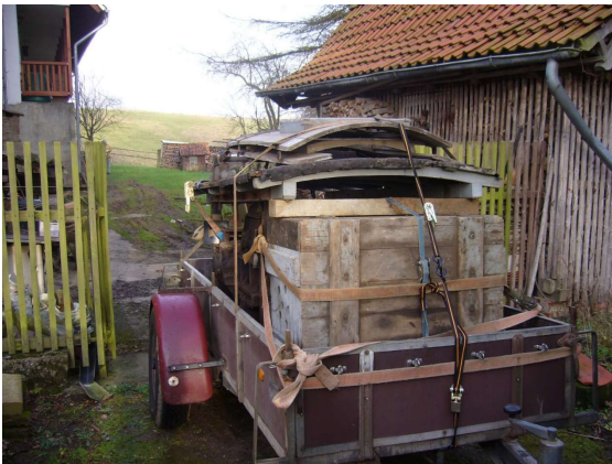
Die ehemalige Dörentruper / Bornhauser-E-Lok Nr. 1 ist verladen. Vorne steht die Holzkiste die den Elektromotor und das Getriebe bedeckt. Auf der Holzkiste und dem Fahrgestell liegt das Dach und darauf die beiden Frontteile mit den Glasfenstern.
