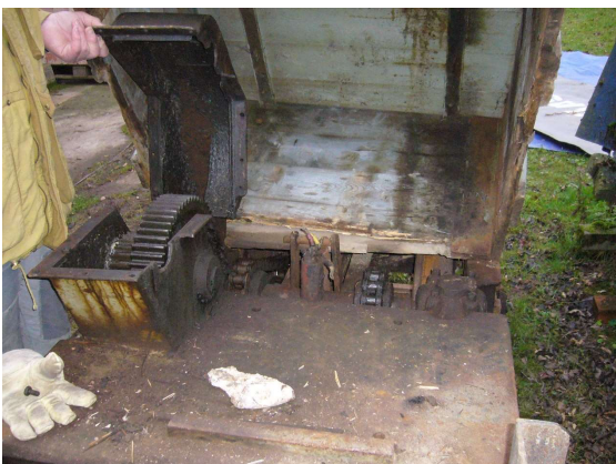
Technisches Detail: Getriebe mit Zwischenwelle für die Antriebsketten mit angehobener Motorkiste.
